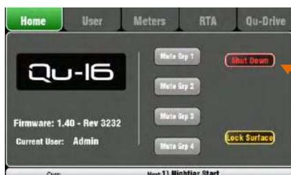
**ミキサーをオフにする：**まず Home 画面を選択します。パラメーターの保存や、USB データ転送、またはレコーディングが完全に、そして安全に処理されるよう Shut Down をタッチします。完了したら電源スイッチを押してミキサーの電源を切ります。
