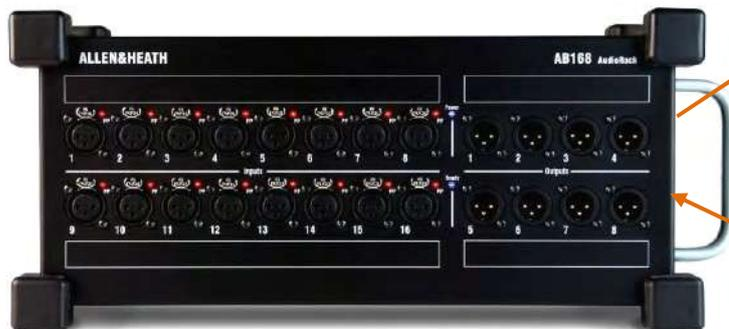
**EXPANDER** : 複数の入力と出力 端子を追加するために、もう 1 台の AB168 と接続します。Allen & Heath ME パーソナルミ キシングシステムとの互換性があります。
