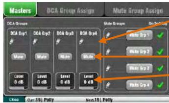
1. すべての Qu Mixer には、Routing 画面の Mute/DCA ビューの Masters タブで DCA マスターコントロールがあります。Fn キーを押します。DCA グループのミュートと解除には Mute を押します。レベルの調整は、DCA Level ボックスを押し、ロータリーを使います。値はボックスに表示されます。
