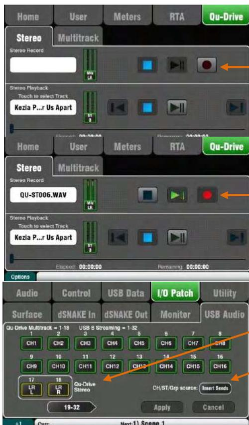
**Qu-Drive の Stereo ページ:** この画面では、トップパネルの Qu ドライブのポートに接続された USB デバイス からステレオへの録音および再生のための設定を行います。
