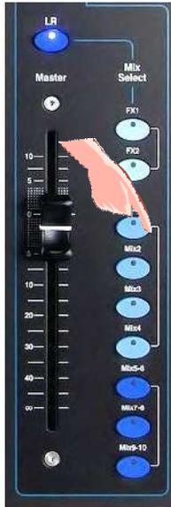
・ **ミックスの選択** : Mix キーを押します。マスターストリップはミックスフェーダーとコントロールがあります。チャンネルフェーダーはそのミックスへ送るために移動します。
