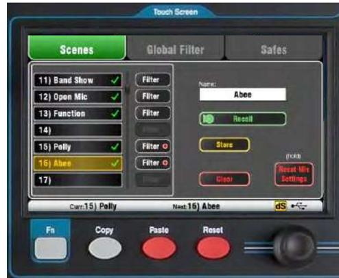
**シーンをコピーする**：Copy キーを押しながらリスト内のシーンをタッチします。他の場所にペーストするには Paste キーを押しながら、他のシーンをタッチします。シーン名と内容がコピーされます。
