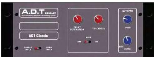
**ADT**：ショートエコー/ コーラス、クラシックダブルトラックと「スラップバック」テープ・ディレイループを作成することのできる自動ダブルトラックモジュールです。ステレオフィールド内のステレオエンハンサーやオートパンが含まれています。ADT は、古典的なダブルトラック効果を生じ、ステージ上での厚みやコーラスの代わりとしてステレオサウンドフィールドの増大に最適です。
