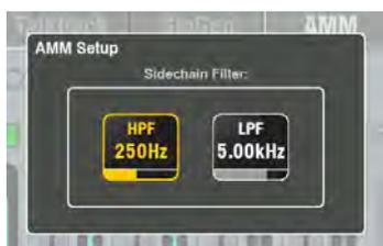
Fn キーを押して、Setup 画面を開き、サイドチェーンフィルターにアクセスします。リセットしたときのデフォルト設定は 250Hz から 5 kHz です。
