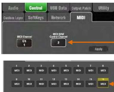
Qu Mixer の MIDI チャンネルを設定する : **Setup / Control / MIDI** 画面を使って Qu の MIDI チャンネルを設定します。Qu DAW コントロールは独自の MIDI チャンネルを使用します。これは他の Qu MIDI メッセージの使用しているチャンネルの次の番号になります。Qu のデフォルト設定では、チャンネル 1 は標準メッセージでチャンネル 2 は DAW コントロールになっています。
