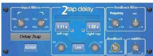
**ディレイ**：入力に左右独立したタップディレイを生成します。ディレイタイムは、スクリーンロータリーを使って回転させる、あるいは画面をタップする、ソフトキーを使ってタップするなどの方法があります。左右のディレイのタップはモノエフェクトを生成するようにリンクさせることができます。フィードバックによりリピーターエコーエフェクトを作成できます。80ms~ 160msの短いディレイタイムで古典的なスラップバックエフェクトも作り出せます。
