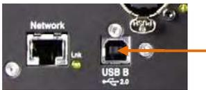
コンピューターに **Qu ミキサーを接続します**：背面パネルの USB B ポートにケーブルを接続します。
