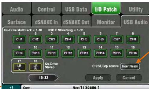
Setup /Output Patch / USB Audio 画面を使ってソースが録音できるようパッチします。トラックボックスをタッチして、ロータリー回してソースを選択します。アサインを増やすには「+1」の Fn キーを押します。CH および ST チャンネルとオーディオグループのグローバルソースを選択します。インサートセンド (デフォルト) またはダイレクト出力です。赤い丸のボタンをタッチすることで録音待機となります。再生ボタンをタッチすると録音を開始します。
