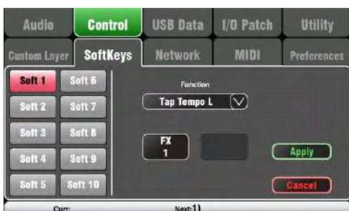
Qu-16にはSoftKeyが4個、Qu-24、32には10個、Qu-Pacには15個装備されています。ユーザーによってそれぞれ異なる機能を割り当てられるので「ソフト」と呼んでいます。Function: ボックスにタッチして開き利用可能な機能のリストから選択します。変更を確定するにはApplyにタッチします。
