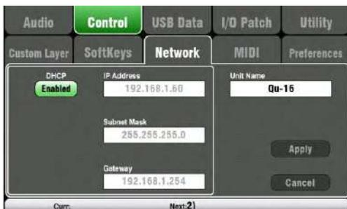
この画面を使用して、ネットワークポートとネットワーク上のクミキサーを識別するために使用される名前と TCP/ IP アドレスを設定します。
