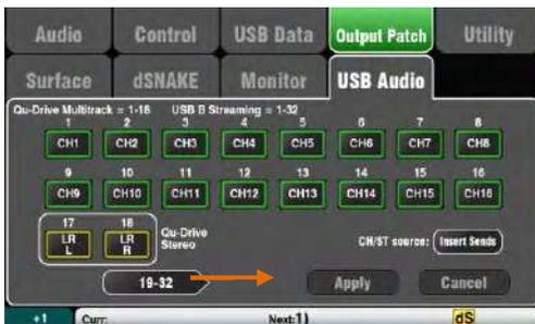
オーディオをコンピューターにストリーミングする：オーディオは、背面パネルの USB B ポートを經由して送信されます。**Setup / Output Patch / USB Audio** 画面に移動し、USB ストリームにどの Qu の出力をパッチするのかが選択します。
