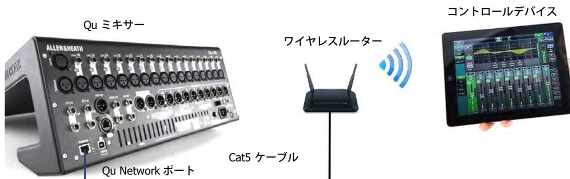
**無線ルーターの選択:** 最高のパフォーマンスを得るためには、自動チャンネル選択を備えたデュアルバンド (2.4 または 5GHz) の無線ルーターを使用することをお勧めします。無線ルーターは、自動チャンネル選択使用可能な、または混在チャンネルで使用可能なものにします。
