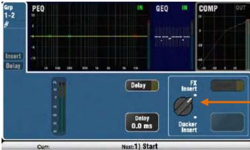
ミックスにパッチが適用されている場合は、Insert で 内蔵 FX のオン/ オフの切り替えが行えます。パッチが適用されている場合は、ボタンが無効になります。FX は EQ より前に挿入されプロセッシングを行います。
