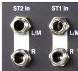
**ステレオライン入力:** ST1、ST2 は、CD プレーヤーのようなラインレベルのステレオソースを接続するバランス 1/4 インチの TRS (Tip, Ring, Sleeve) 端子です (Qu-SB には ST2 は装備されていません)。L 入力端子は R 入力端子と繋がっているため、モノラルソースを接続する際には L/M 入力端子を使用します。
