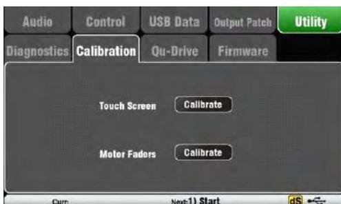
モーターフェーダーの位置の精度とタッチスクリーンの精度を調整するには、このユーティリティを使います。
