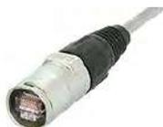
Qu Mixer は、過酷なツアーに適合できるように、接続を保護する堅牢でロック可能な Neutrik EtherCon 端子を採用しています。この EtherCon の接続に対応できるツーリンググレードのケーブルをお使いください。最大ケーブル長 = 120 メートル (396 フィート)。ケーブルのタイプによって左右されますが、推奨の最大ケーブル長は 100 メートル (330 フィート) です。
